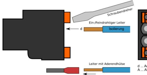
d ... Aderquerschnitt A ... Abisolierlänge
